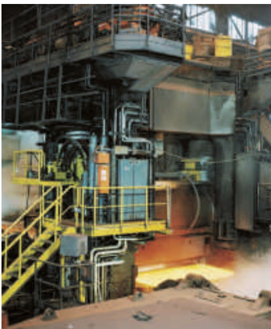
1 5,1-m-Quarto-Grobblechstraße der Mannesmannröhren Mülheim GmbH 5.1 m rolling mill of Mannesmannröhren Mülheim GmbH
